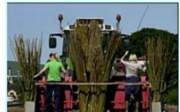
バイオマスヤナギ植え付け機械。 長いヤナギを25センチの挿し穂に機械が切って自動で植えつける。
