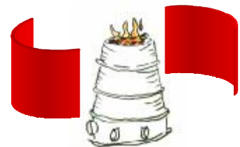
最後に本体にカバーを取付け、隙間に砂を詰めて断熱する。
